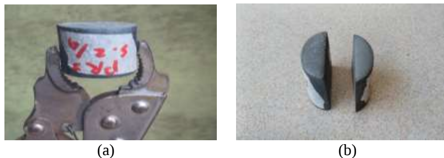
Gambar 4. Visualisasi ketebalan spesimen variasi suhu spesimen: (a) Suhu 828°C, (b) 602°C dan suhu 712°C
